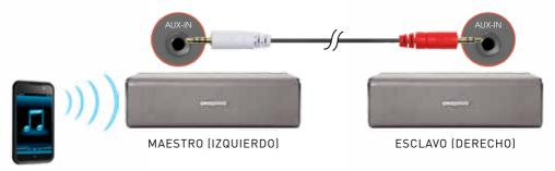
Solo tiene que conectar el extremo blanco del cable a la entrada auxiliar del altavoz izquierdo, la parte roja a la entrada auxiliar del altavoz derecho y poner al máximo el volumen para disfrutar.
