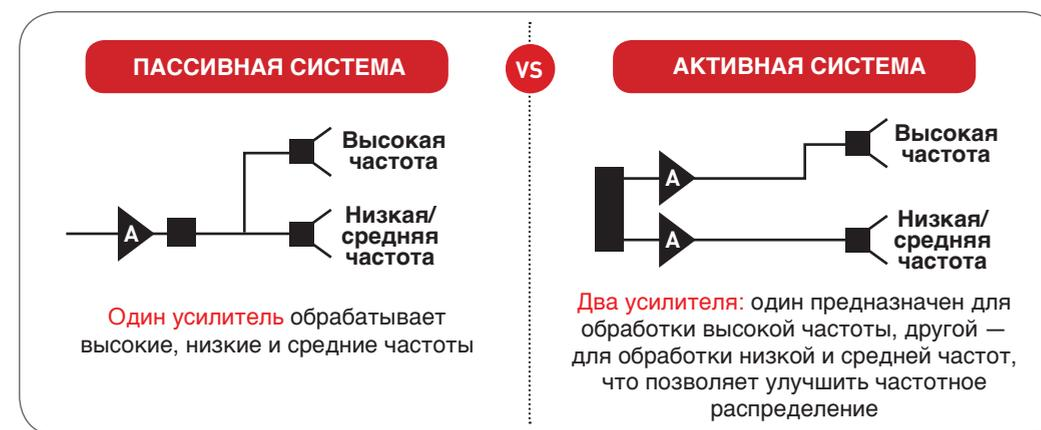
В большинстве портативных динамиков для воспроизведения всего звукового спектра используется только один усилитель. В конструкциях с одним усилителем большая часть мощности расходуется на воспроизведение низких и средних частот, передача же высоких частот при этом страдает.
